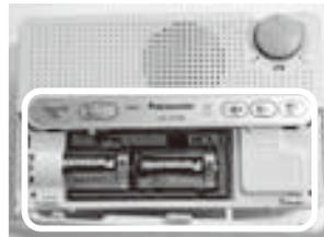
乾電池は正面のカバーを外して交換してください。(単一電池2本が必要です)
