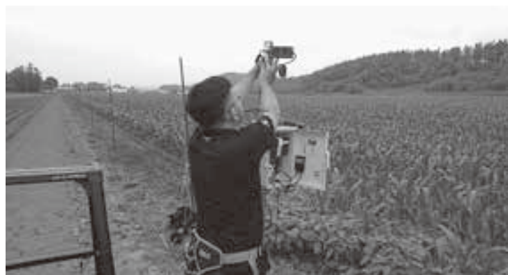
試験的に鹿ソニックを設置している
