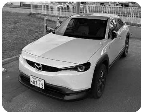
公用車の電気自動車。ガソリンがあれば発電できるため災害時に発電機として活用できる
